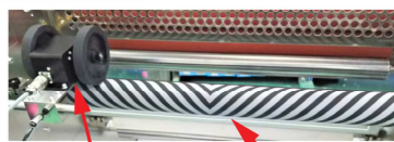
ラミネート量測長機能 しわ伸ばしロール
